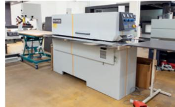
Mit integriertem Beilemaggregat zur Verklebung von Furnierstreifen in einer Dicke von ca 0,35 bis 2,5 mm, Kompaktkühlung, Optionspaket Starkfurnier für Furniere bis 5,0 mm Dicke.
