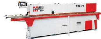
Radiusziehklängenaggregat, Flächenziehklängenaggregat, Schwabbelaggregat, Aufpreis EVA/PUR Leimbecken, Aufpreis Diawerkzeuge H=65mm, Riepe Antihalt-Sprüheinheit Fügeaggregat, Riepe Reinigungs-Sprüheinheit am Ausgang, aut. Positionierung der Aggregate, mot. Oberdruck, Bed. über Touchscreen, pneum. Einst. RZ. Und FZ für AN/AUS Pos., Rohrsystem mont. D=200 mm
