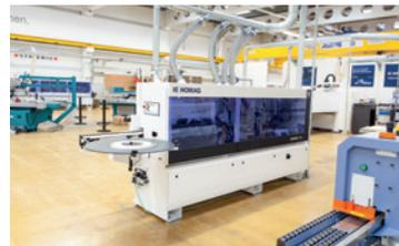
Vakuum flächenabhängig, Dickenmessgerät per Funk ME 5000, Upgrade 3 Magnetdruckbalkensystem MPS 2.0 PLUS, Mit- und Gegenlaufeinrichtung, Bandabblasvorrichtung regelbar 1350 mm, Bürstaggreat strukturieren K80, Reinigungsanlage integriert, Gurtreinigungsprogramm, Vintage Look quer und längs.
