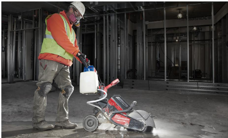
Der Akku-Trennschleifer MXF COS350-601 mit Führungswagen MXF COSC ist bestens geeignet für gerade Schnitte über längere Distanzen.
