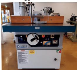
BJ 13, Starrfräse, 4 kW, 30 mm Fräsdorn-Ø, 1500/3000/4500/6000/9000 U/min., manueller Stern-Dreieckanlauf, Steckdose für Vorschubapparat.
