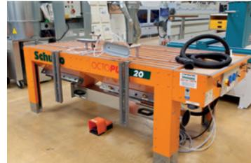
Mechanische Höhenverstellung, Vakuum-Spanneinrichtung komplett, Spezialsaugpistole mit Schlauch.
