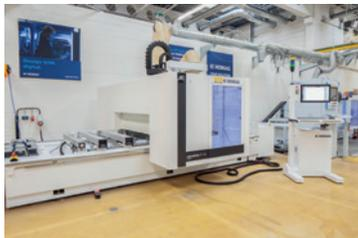
Future 10 kW, K-Tisch LED "M" (LED-Positionierung), Komfort-Bedienung, 1x Vakuumpumpe (63 m³/h), Maschinendaten erfassen und auswerten MMR, WOODWOP LAMELLO CLAMEX-P, WOODWOP OFFICE PROFESSIONAL, 3D SIMULATION, CAM-Plugin -> Maschine & AV.
