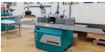
7,5 kW, Tischverlängerung beidseitig mit ausziehbarer Werkstückauflage, Fräsanschlag-Schutzvorrichtung CENTREX, Integralanschlag 650/500 mm, inkl. Füllstab, Wegschwenkvorrichtung für Fräsanschlag, Konsole für Vorschubstativ - Anbau links, Zentralschmierung über Ölpumpe, Fräsdornflansch SK 40 Ø30 ProLock Schnellspannsystem, 3-Rollen-Vorschubapparat Variomatic 3N (mit Komfort-Stativ).
