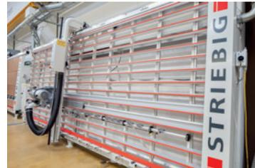
Vertikale Plattensäge, Schnittbereich L x Hvert x Hhor 5300 x 2240 x 2100 mm, Set für freistehende Montage.
