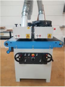
2x 4,0 kW, Oszillierende Vorrichtung für 1. Bürste und 2. Bürste, Bürste aus Tynex K 46, K 60.
