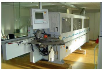
BJ 07, Vorkapschere für Dick-PVC/ABS max. 3x45mm, Elektroniksteuerung Power Control PC 20+, 8 - 60 mm Werkstückdicke, 8 - 16 m/min Vorschub, motorische Verstellung: Oberdruck, Einlauflineal verstellbar, Druckzone. Quickmelt Vorschmelzer, Trenn- und Reinigungsmittelabgabe, Fügefräsaggregat, Kappaggregat, Bündigfräse, Formfräsaggregat, Ziehklinge mit Schnellwechsellköpfen, Schwabbeln.
