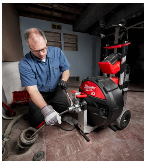
Der Akku-Rohrreiniger MXF LSDP-301 für die Reinigung von Abflüssen mit 75 mm bis 200 mm Durchmesser.
