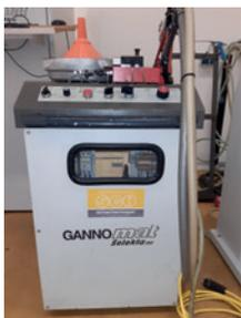
BJ 06, autom. Dübellängen- und Dübel-Ø Kontrolle, Vollautom. Elektroniksteuerung mit Programmwahlschalter SPÜLEN-LEIMEN-LEIMEN/ EINTREIBEN, 8-stufiger Leimmengenwahlschalter m. Zeitvorwahl d. Elektroniksteuerung, geschl. Leimsystem 6 bar Leimdruck ü. Leimdüse f. Leime m. einer Viskosität v. 150 bis 350 mPas, Wahlschalter LEIM/WASSER zum Spülen des Leimsystems, je 1 Edelstahlbehälter für 5 kg Leim und 5 l Wasser zum Spülen.
