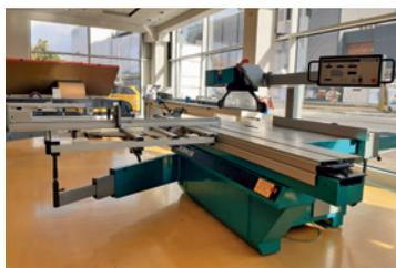
BJ 97, schwenkbar, 3300 mm Schnittlänge, 1050 mm Schnittbreite, min. 200 / max. 500 mm Sägeblatt-Ø, 400V / 50Hz / 15A, 2800 / 4400 / 5500 U/m., Digitalanzeige für Höhen- u. Breitenanzeige Schwenkung, vorführbereit\*.
