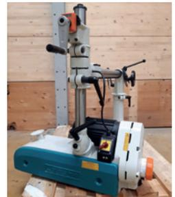
BJ 17, 400 V Spannung, 4 Achsen, 2 - 18 m/min. Geschwindigkeit re/li, 87 kg, Universalstativ aus Guss und geschl. Führungsrohren mit Schwenkgelenk zum horizontalen und vertikalen Einsatz, Horizontales Auslegerrohr 1050 mm lang, vorführbereit\*.
