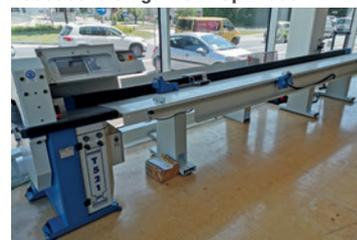
BJ 12, 4,7 kW, 450 mm Sägeblatt-Ø, 3000 mm Rollentisch links, 6000 mm Rollentisch rechts (autom. Zufuhr), vorführbereit\*.
