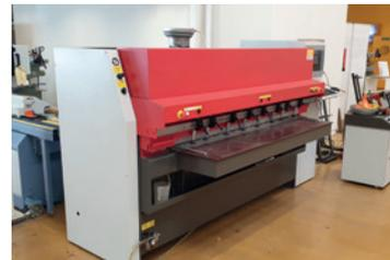
BJ 05, Automatikstart der Maschine, elektronisches Leimüberwachungssystem GIC, 4 vertikale Spannzyylinder 10° zusätzlich, Anschlagssystem Winkelfehlerausgleich, Gehrungsanschlag 45°, Sensorabfrage Gehrungsanschlag, Barcodelaser, Software Netzwerkanbindung TC Programmiersystem, vorführbereit\*.
