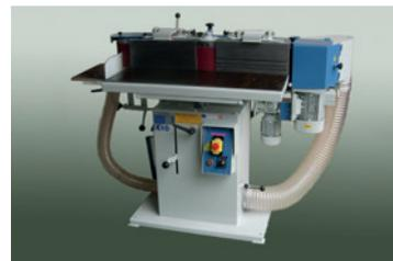
Aufklappbare Furnierkantenschleifeinrichtung, oszillierendes Schleifband, Schleifbandabmessung 150 x 2600 mm, Gehrungsanschlag mit Skala, Fahrwerk.
