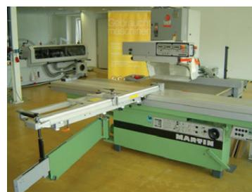
BJ 97, schwenkbar, 3300 mm Schnittlänge, 1005 mm Schnittbreite, min. 200 /max. 500 mm Sägeblatt-Ø, 400V / 50Hz / 15A, 2800 / 4400 / 5500 U/m., Digitalanzeige für Höhen- u. Breitenanzeige Schwenkung, Generalüberholt, incl. CE-Zertifikat und 6 Monate Gewährleistung.
