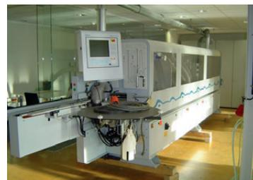
BJ 07, autom. Magazin, EVA / PUR Kleber, 0,4 - 12 mm Kantenstärke, Vorkapschere für Dick-PVC/ABS max. 3x 45 mm, Elektroniksteuerung Power Control PC 20+, 8 - 60 mm Werkstückdicke, 8 - 16 m/min. Vorschub, motorische Verstellung Oberdruck, Einlaufinleak verstellbar, Druckzone, Quikmelt Vorschmelzer, Trennmittelangabe,
