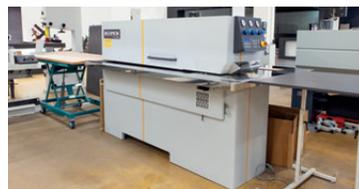
Furnierzusammensetzmaschine mit integriertem
