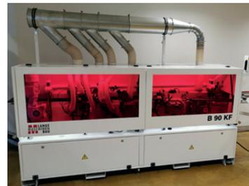
mm Kantenstärke, Kappen, Bündigfräsen, 400+N V /3/ 50 Hz, Radiusziehklingenaggregat mit Abblasvorrichtung + Absaugung, Flächenziehklinge, auto. Positionieren der Aggregate mit 2 vorgegebenen Kantenstärken mit 1,0 mm und 2,0 mm, pneum. Einstellung (AN/AUS) Flächenziehklinge, Rohrsystem mit 90° Bogen an Maschine montiert, Diamantwerkzeug Fügeaggregat Höhe 65mm.
