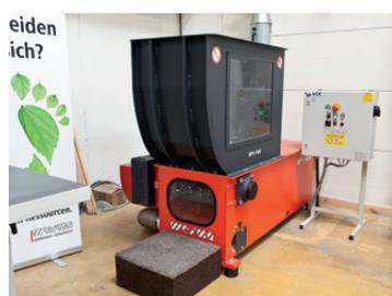
18,5 kW, 2te Messerreihe, Logspacer (freischnei-
