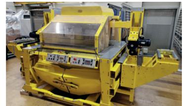
BJ 04, 15 kW, 3.000 U/min Drehzahl, 750 mm Sägeblatt-Ø, 295 mm Schnitthöhe 90°, 200 mm Schnitthöhe 45°, 137 mm Schnitthöhe 30°, 2m Rollenbahn rechts, inkl. CE Zertifikat und 6 Monate Gewährleistung.
