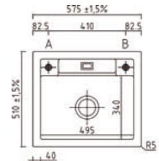
Keine Armaturbohrung vorhanden.
