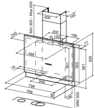
**Nautilus Technologie:** der neue Faber Luftverteiler ermöglicht eine Verbesserung der Energieeffizienzklasse von C auf A und die erste wirklich senkrechte Dunstabzugshaube. Abluftanschluss 150 mm (Reduzierstück auf 120 mm im Lieferumfang enthalten) Metallfilter herausnehmbar und waschbar, 50 cm Mindestabstand zum Kochfeld Oberkamin ohne Schlitze, beim Umluftbetrieb muss ein geringer Abstand zum Schacht eingehalten werden inkl. Schacht
