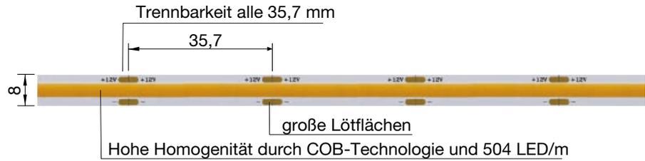
LED-Band mit COB-Technologie mit 504 LED/m, die unter einer gemeinsamen Phosphorschicht liegen. Dadurch entsteht ein sehr gleichmäßiges homogenes Lichtband ohne sichtbare LED-Punkte.
