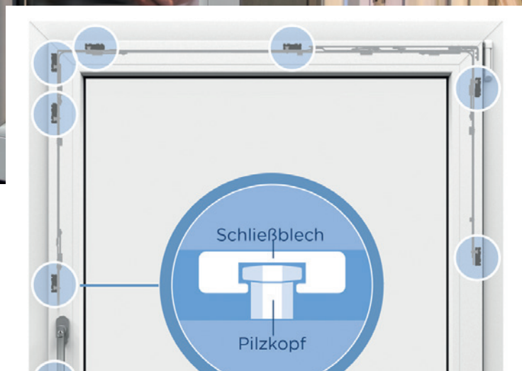
Die Fensterbeschläge sitzen unauffällig im Fensterfalz und schützen vor dem Aufhebeln.
