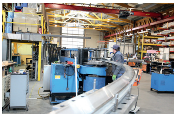
Insgesamt stehen fünf PBT-Maschinen von Schachermayer für das Biegeservice bereit.
