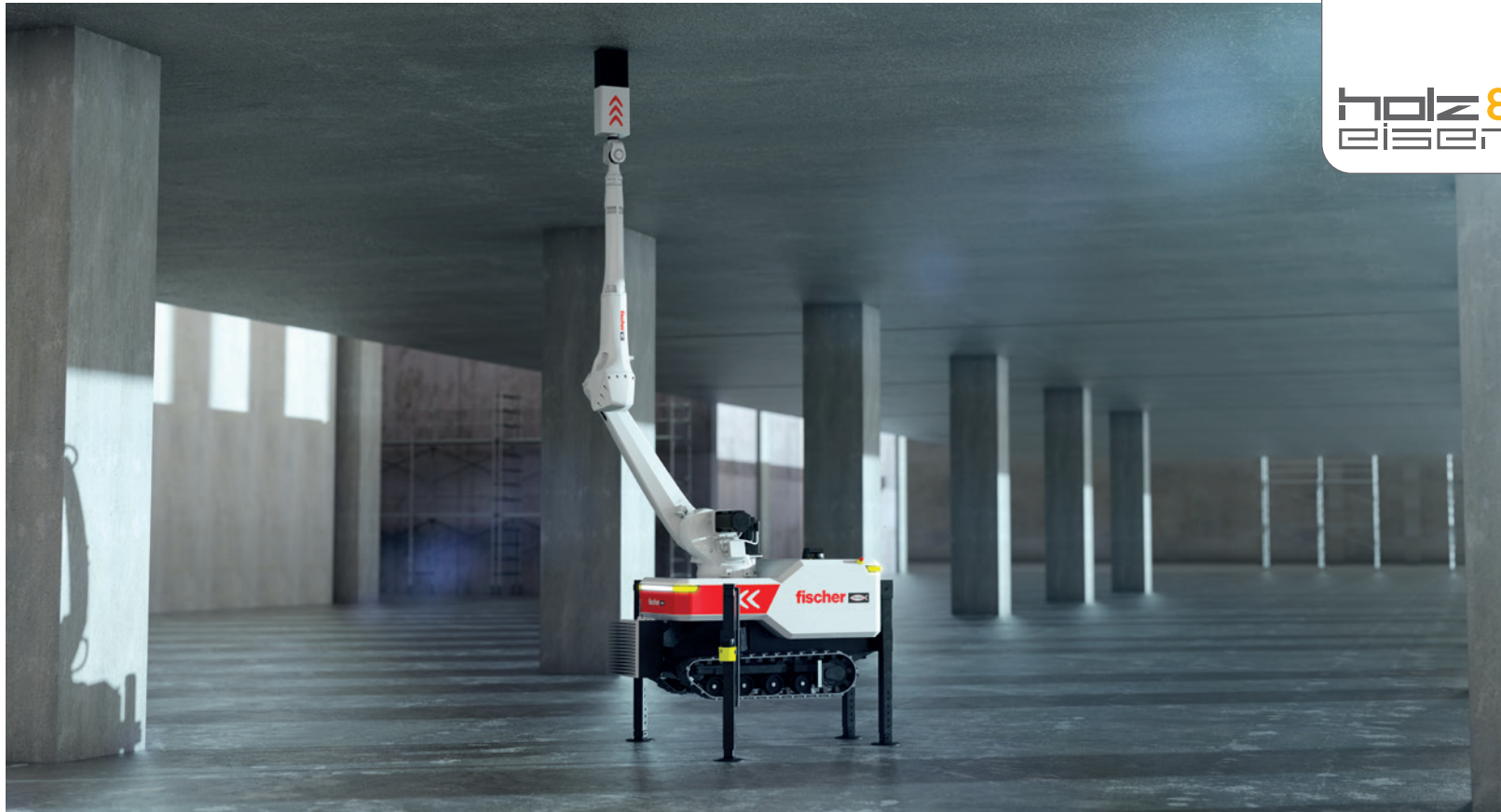
Willkommene Unterstützung: Handwerker werden durch den Einsatz des BauBot' körperlich entlastet und deren Gesundheit durch eine staubfreie Umgebung geschützt. Dabei eignet sich der innovative, vollautomatische Helfer für Boden-, Decken- und Wandanwendungen.
