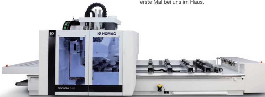
Das neue HOMAG CNC Bearbeitungszentrum Centateq P210 mit Aggregateschnittstelle und digitalen Assistenten.
