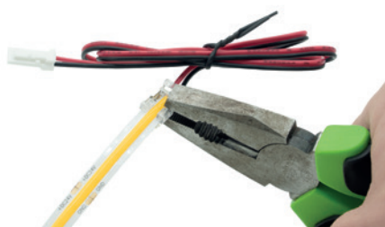
Band und Bandverbinder werden ganz einfach mit einer Kombizange verpresst.
