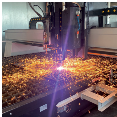
Die hochmoderne Plasma-Schneidanlage ist ebenfalls ein wichtiger Bestandteil im effizienten Produktionsprozess.
