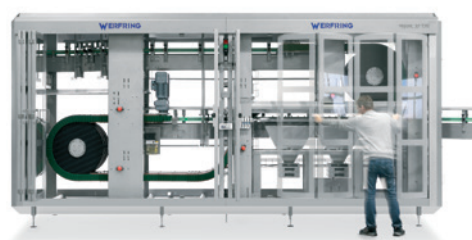
Der Hygienic Jet 1000 reinigt Leergebinde mithilfe eines hocheffizienten Ausblassystems.
