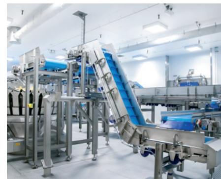
Für die Firma Eisberg produzierte Werfring eine Hygieneförderanlage inklusive Edelstahl-Podest.
