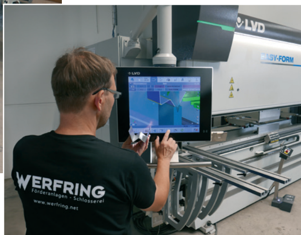
Schachermayer lieferte Werfring eine LVD-Abkantpresse Type Easy-Form inklusive externer Programmiersoftware Cadman B.
